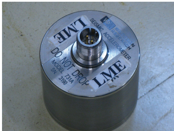
Figura A.4: Acelerômetro tipo piezoelétrico utilizado nas medidas de vibração
