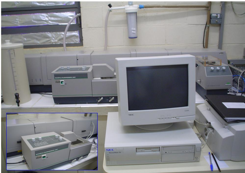
Figura 5.4.- Mastersizer S marca Malvern utilizado na caracterização do permeado. Os dados obtidos são processados diretamente por um computador NEC que é parte do sistema. Na parte inferior esquerda da figura é mostrado o recipiente onde é colocada a solução que será analisada assim que começar a circular para a cavidade de análises.
