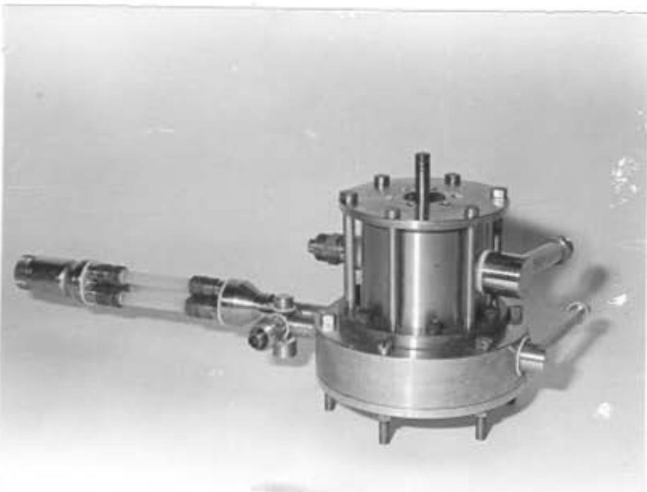
Fig. III.12. Aspecto externo da bomba do corante.
