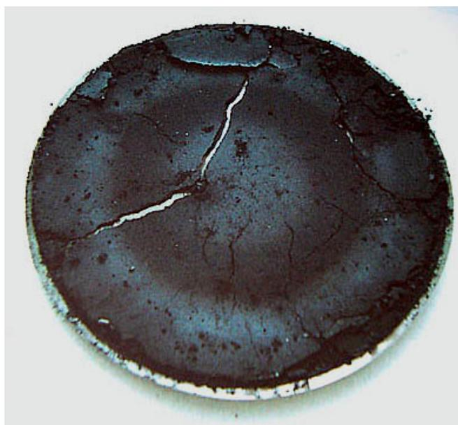
**Figura 2. 3: Fotografia de um alvo de  $\text{LiNiO}_2$  trincado após bombardeamento.**
