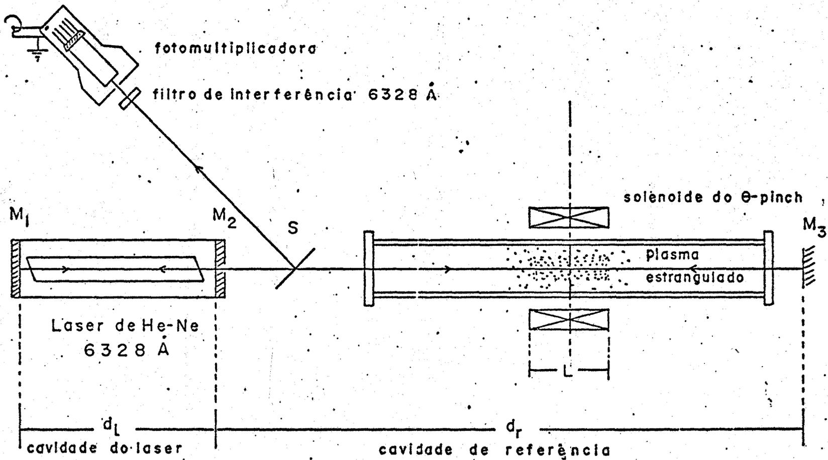
Fig. (II.B.4): INTERFERÔMETRO DE LASER
