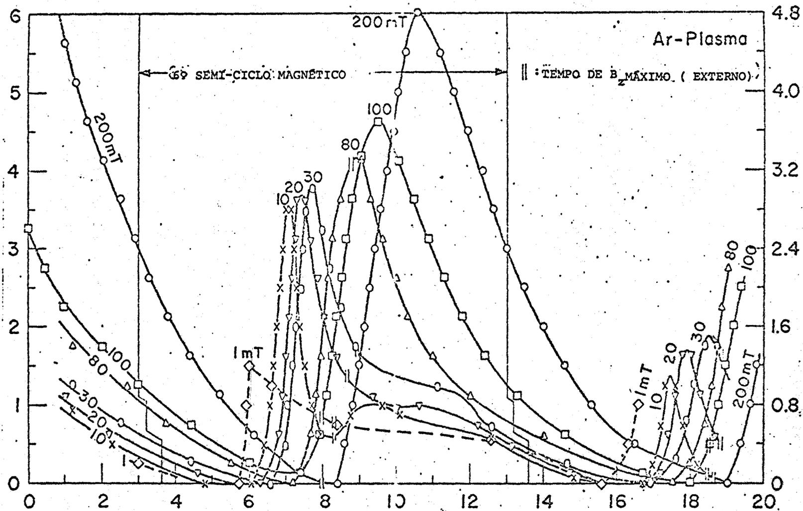
Fig. (III.9): EVOLUÇÃO TEMPORAL DA DENSIDADE DE ELÉTRONS EM FUNÇÃO DA PRESSÃO INICIAL.
