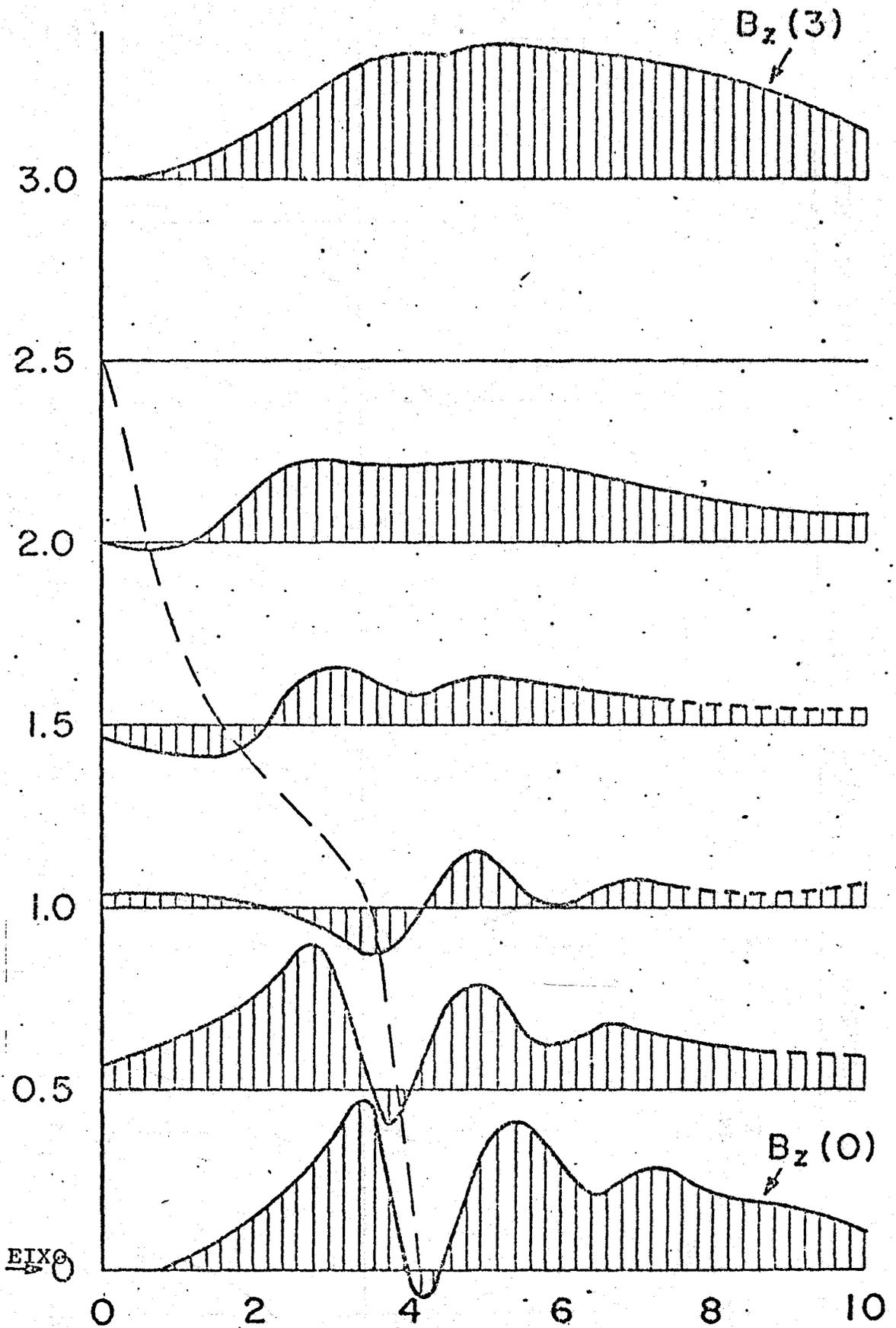
Fig. (III.6): VARIACÃO RADIAL DO CAMPO MAGNÉTICO EM FUNÇÃO DO TEMPO.
