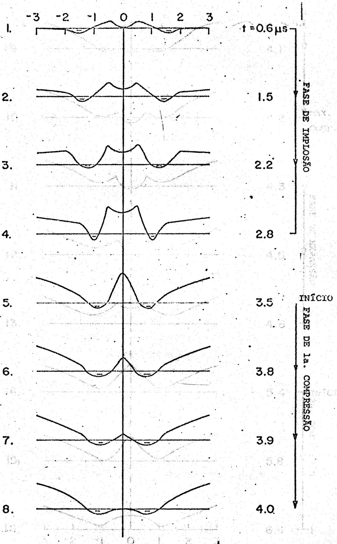
Fig.(III.7): EVOLUÇÃO TEMPORAL DA DISTRIBUIÇÃO DE CAMPO MAGNÉTICO DURANTE O 60° SEMI-CICLO.
