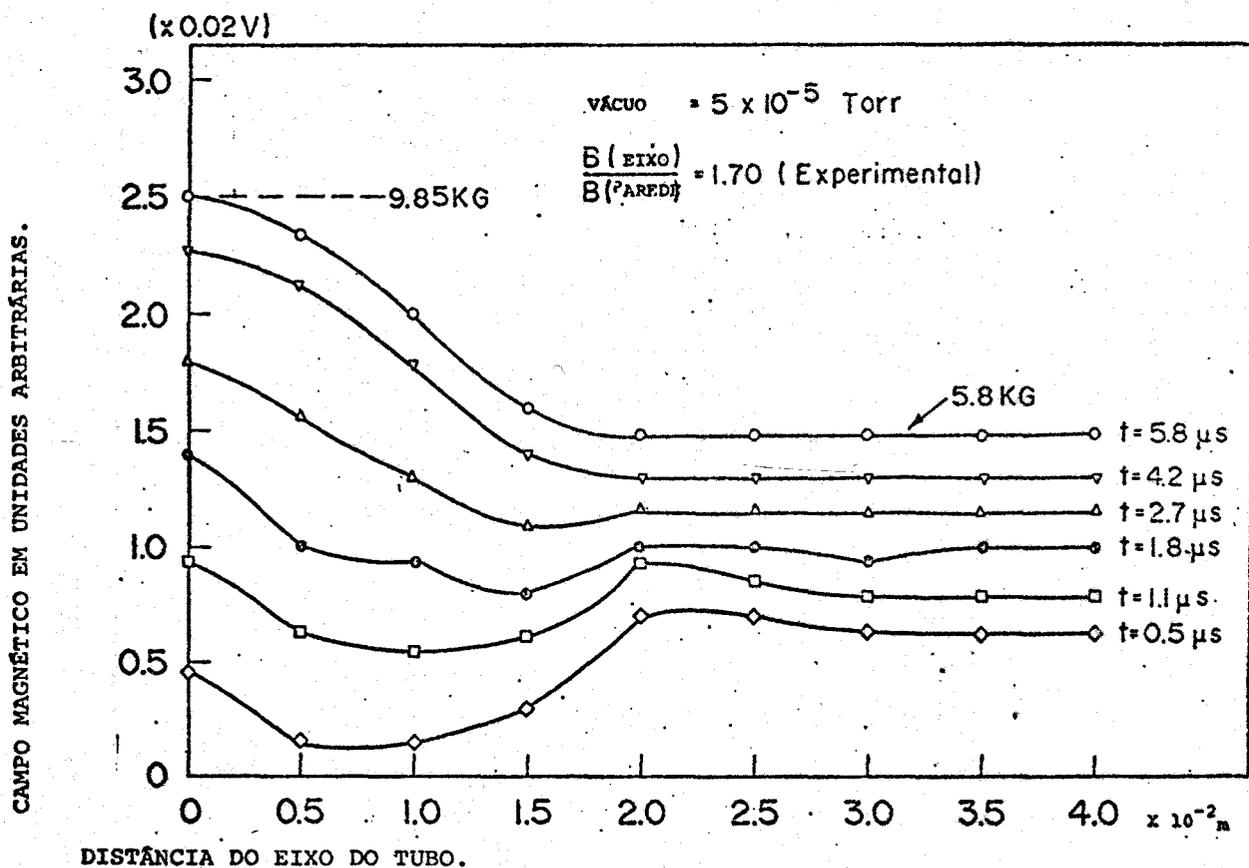
Fig.(III.4): MEDIDAS DE CAMPO MAGNÉTICO NO VÁCUO.
