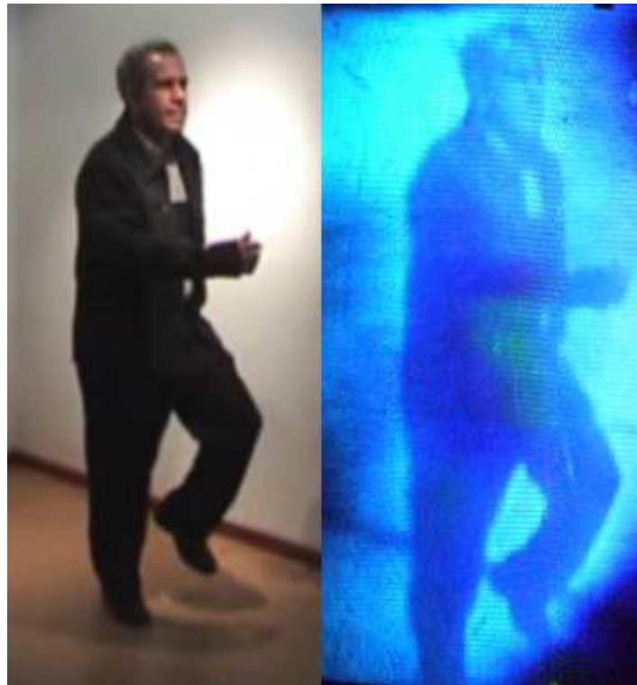
Figura 4.6: À esquerda, a imagem de video projetada e à direita a imagem visualizada no sistema de holoTV utilizando uma tela holográfica simples.
