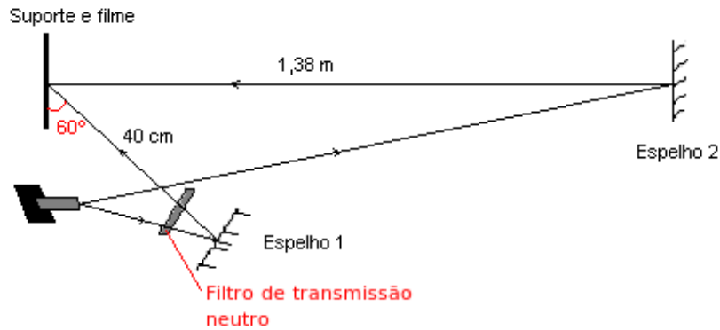
Figura B.1: Sistema holográfico utilizado para gravar uma tela holográfica simples com laser de diodo.
