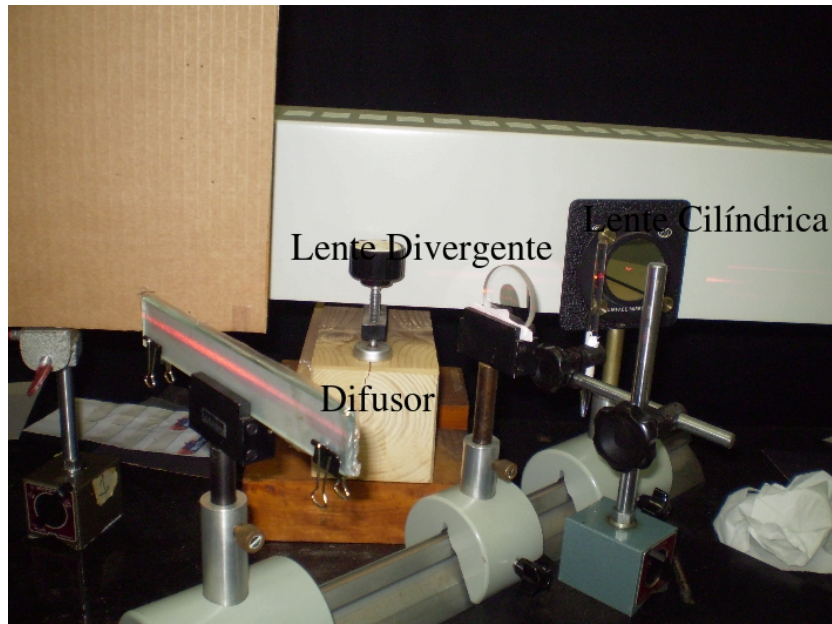
Figura 5.4: As dimensões do difusor e lentes envolvidas na gravação.
