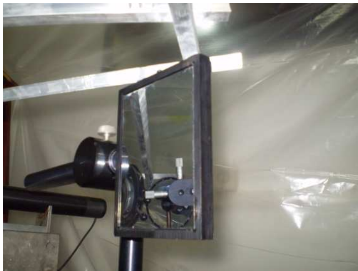
Figura C.4: As barras coladas sobre um dos espelhos planos; atrás o filme plástico.
