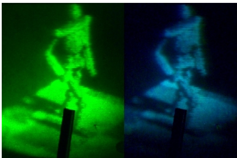
Figura 7.3: À esquerda a imagem vista pelo olho esquerdo e à direita a imagem visualizada com o olho direito. A comparação entre a imagem e o bastão mostra que a distância da imagem é 27 cm a frente da tela.
