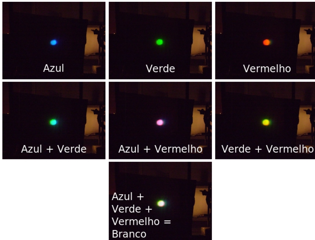
Figura 8.7: Na primeira linha vemos as imagem gerada por cada um dos projetores individualmente, abaixo tomados dois a dois e finalmente todos juntos, gerando a imagem branca.
