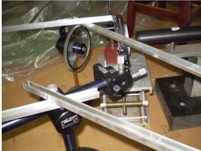
Figura C.3: O divisor de feixes e um dos filtros espaciais estão fixos a outros elementos ópticos por meio de barras coladas com matacrilato.
