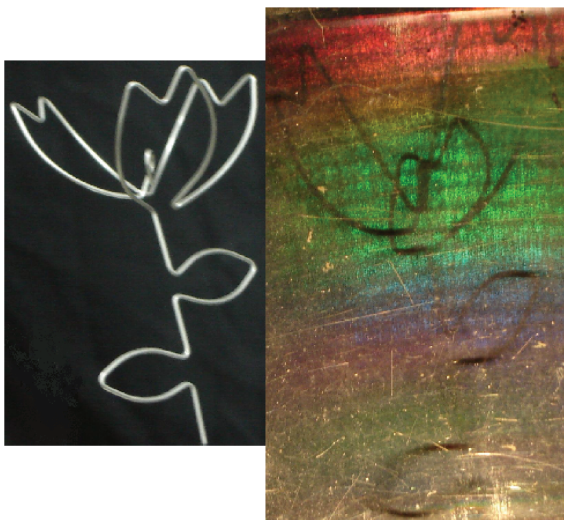
Figura B.3: À esquerda, o objeto utilizado para a visualização da imagem e à esquerda a imagem visualizada com a tela holográfica.
