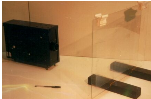
Figura F.1: Holoprojetor por lente horizontal
