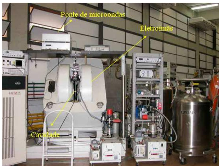
Figura 3.1. Um típico espectrômetro de EPR.
