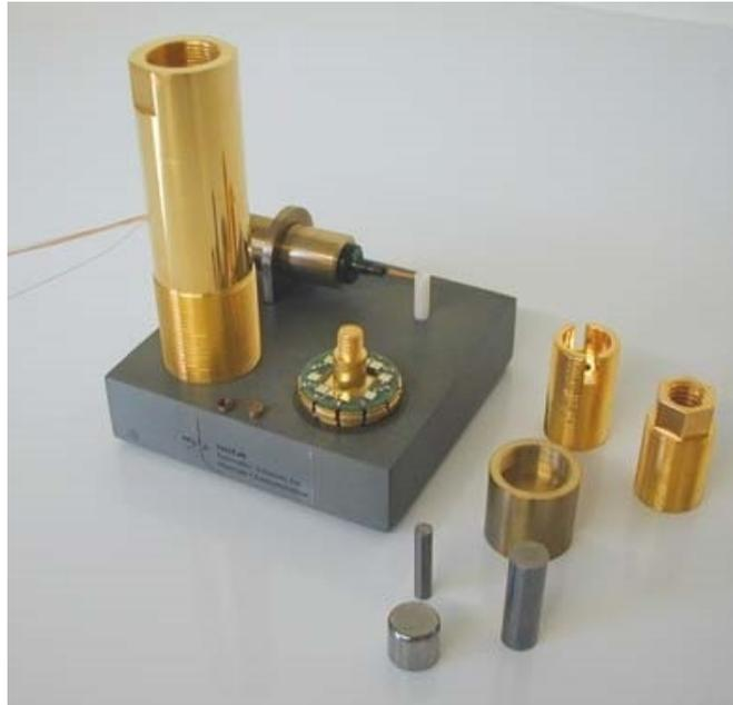
Figura 3.1.: Foto da célula de pressão e seus componentes. Figura extraída do manual da célula.
