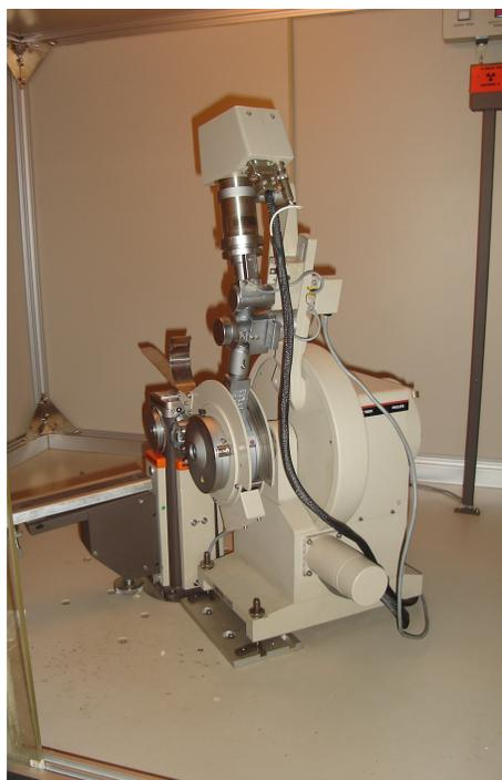
Figura 3.8: O difratômetro de raios-X Philips utilizado neste trabalho
