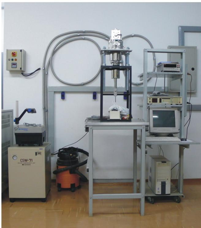
Figura 3.10: O criostato de ciclo fechado de hélio, com um sistema para medidas de resistividade instalado.
