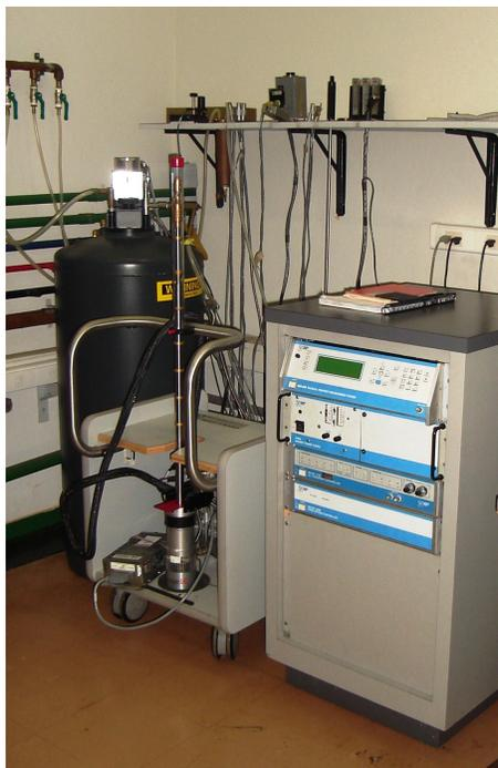
Figura 3.6: O PPMS, modelo PPMS-9 (Quantum Design), utilizado neste trabalho.
