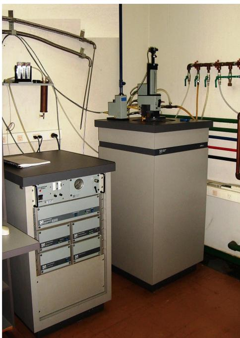
Figura 3.3: O SQUID, modelo MPMS-5, da Quantum Design, utilizado neste trabalho.
