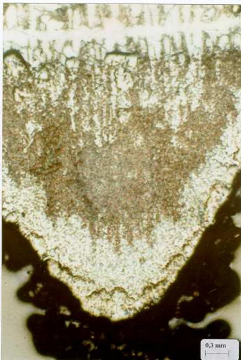
Figura 16-) Micrografia da amostra  $Fe_{15}Pr_{85}$  obtida com a técnica de solidificação direcional a uma velocidade de 1 mm/h (Aumento de 32 vezes). Parte inferior da amostra
