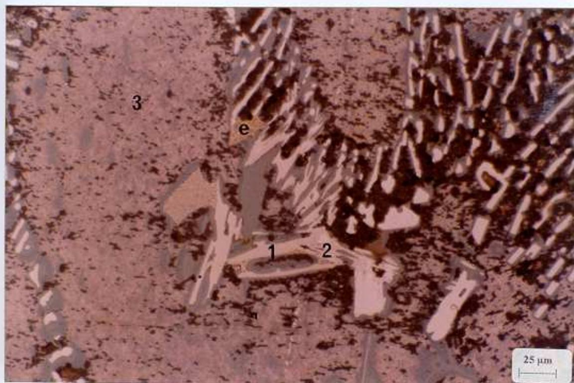
*Figura 19-) Micrografia da amostra Fe<sub>15</sub>Pr<sub>85</sub> solidificada direcionalmente a 20 mm/h (Aumento de 400 vezes). (E) Fase amarela de composição desconhecida, (1) formação peritética da fase Fe<sub>2</sub>Pr, (2) formação da fase Fe<sub>17</sub>Pr, (3) precipitação primária da fase Pr*
