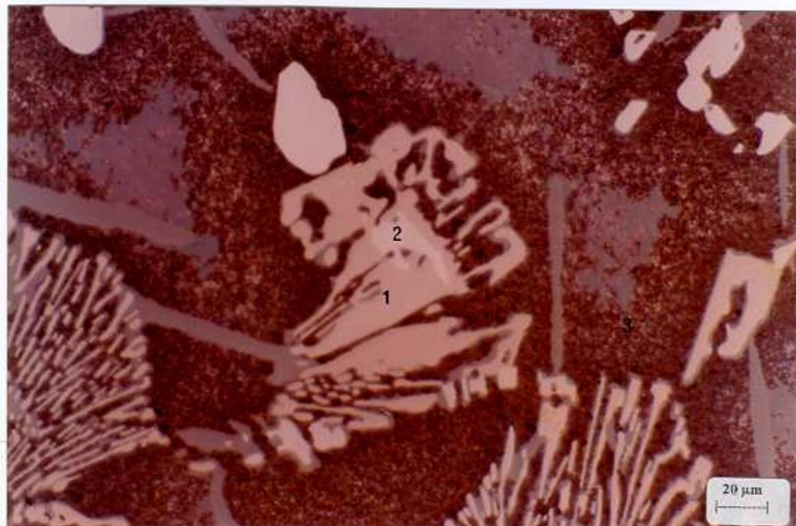
*Figura 40-) Micrografia da amostra Fe<sub>30</sub>Nd<sub>70</sub> obtida do calorímetro Calvet (Aumento de 500 vezes) (1) formação peritética da fase Fe<sub>2</sub>Nd, (2) formação da fase Fe<sub>17</sub>Nd<sub>2</sub>, (3) precipitação primária da fase Nd.*
