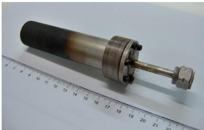
Figura 2-7: Reator utilizado no processo de hidrogenação das ligas de Gd-Ge-Si.
