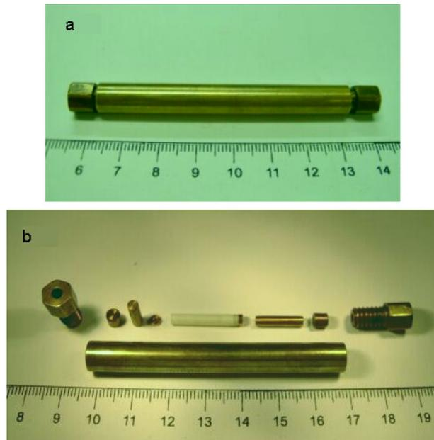
Figura 2-13: Fotografia da célula de pressão utilizada nas medidas magnéticas sob pressão hidrostática. (a) A célula montada e (b) desmontada, onde pode-se ver a cápsula de Teflon<sup>®</sup> (cilindro branco), no interior da qual inserem-se as amostras.
