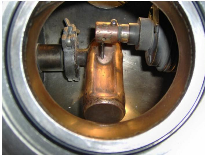
Figura 2-1: Fotografia da parte interna do nosso forno a arco voltaico.
