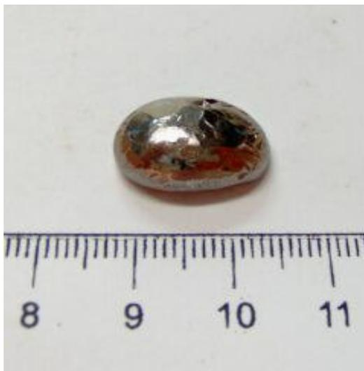
Figura 2-2: Fotografia de um botão de 5 g resultante da fundição do composto Gd<sub>5</sub>Ge<sub>4</sub>.
