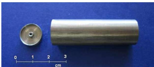
**Figura 3.4-1** Cadinho de Nb utilizado nas reações de estado sólido da série  $\text{FeMnP}_{1-x}\text{As}_x$ . Utilizando este método foi produzida a estequiometria  $\text{FeMnP}_{0,47}\text{As}_{0,53}$  que foi tratada por 11 dias a 1323 K em forno resistivo tubular vertical. O resfriamento da amostra foi condicionado pela inércia térmica do forno que foi simplesmente desligado e deixado resfriar.
