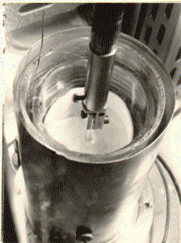
Foto 2 Detalhe do forno de crescimento
