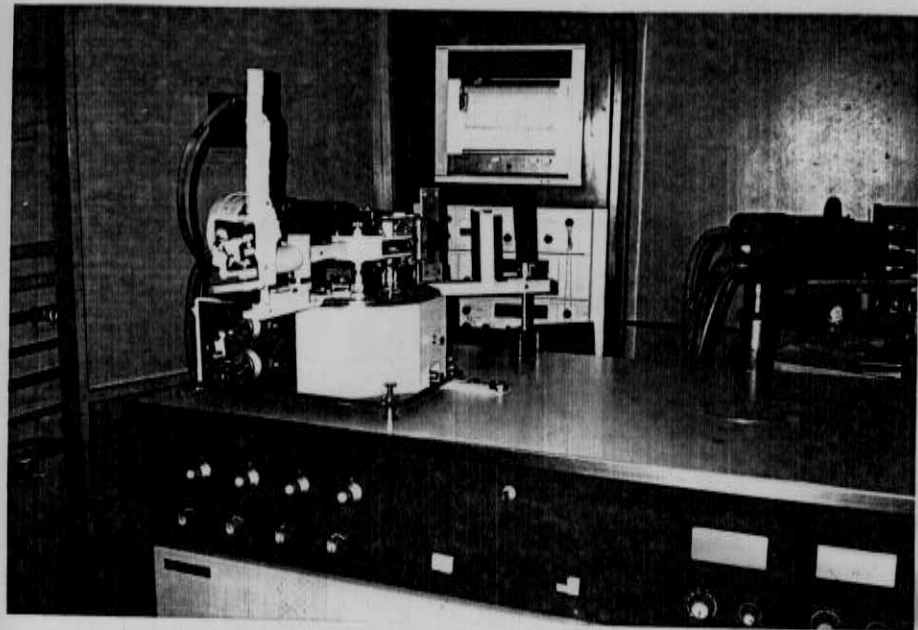
Vista geral da montagem para se obter imagens fluorescentes com a radiação total emitida por um gerador de raios X de uso cristalográfico.
