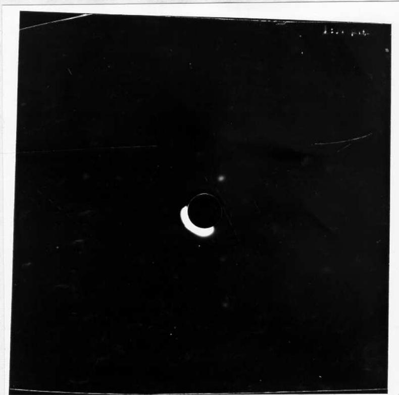
FIGURA (III-2) RADIAÇÃO DIFUSA DEVIDO AOS DEFEITOS: CRISTAL DE LiF IRRADIADO COM NEUTRONS. ORIENTAÇÃO: PLANO (100) CONDIÇÕES DO DIAGRAMA: 40 KV, 30 mA, ANITCÁTODO - Mo, - TEMPO EXPOSTO - 30 MINUTOS.
