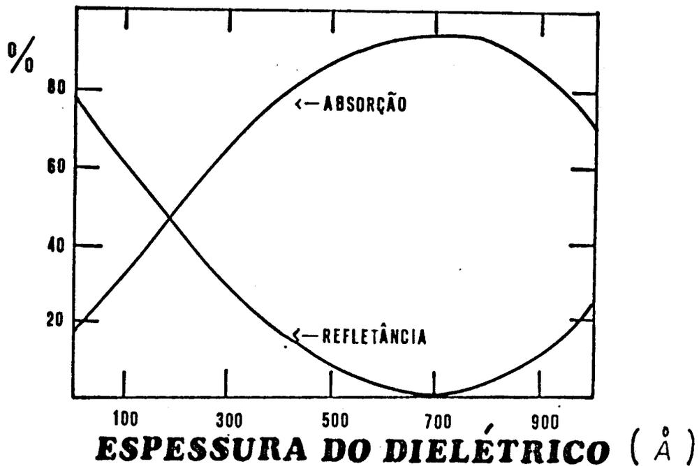
Figura 5.2 Dependência da absorção e refletância em função da espessura da camada dielétrica numa estrutura de três camadas.
