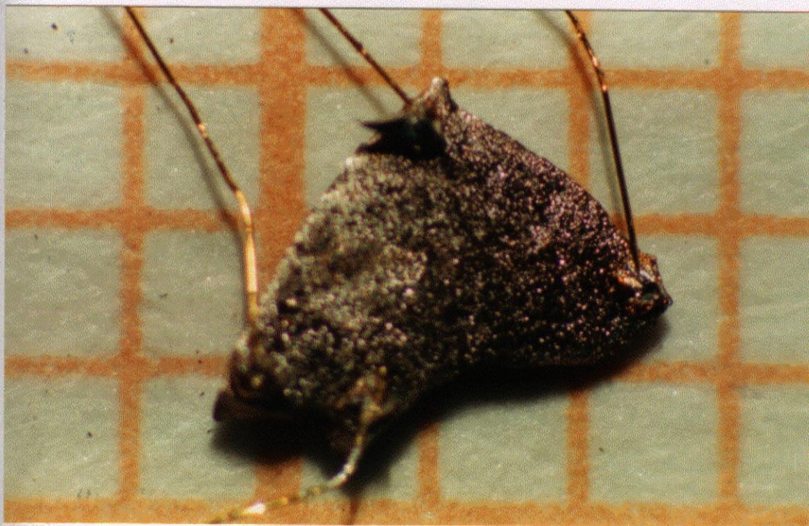
Figura 4-III. Foto da amostra de Nb-Pt com os contatos de In e fios de Au (  $25\mu$  ) já soldados.
