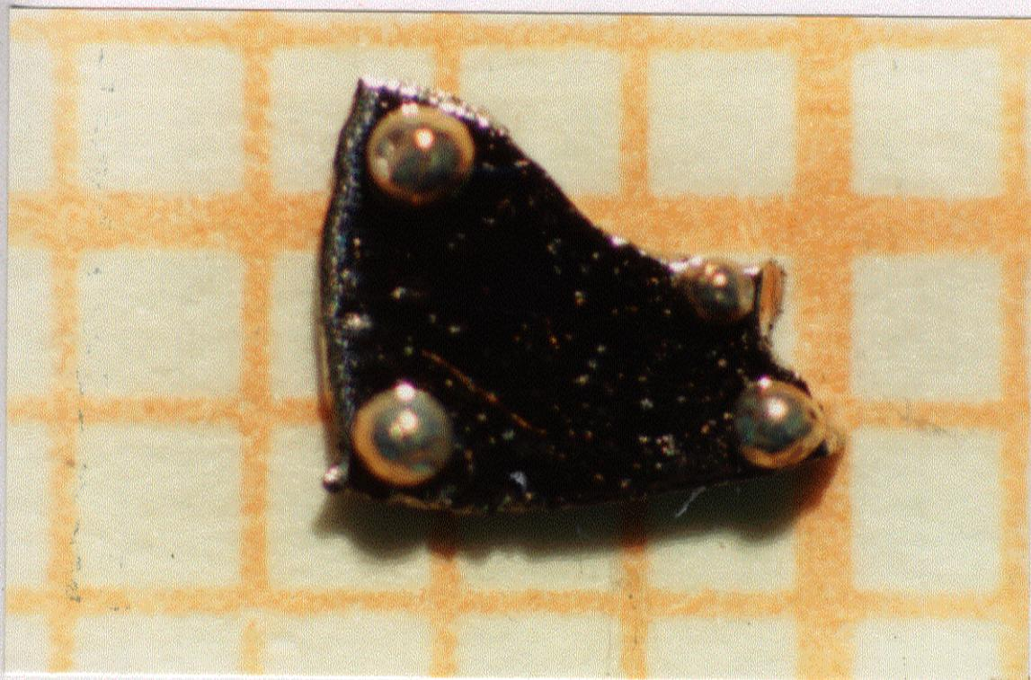
Figura 3-III. Foto da amostra de Nb-Pt com os contatos de In.
