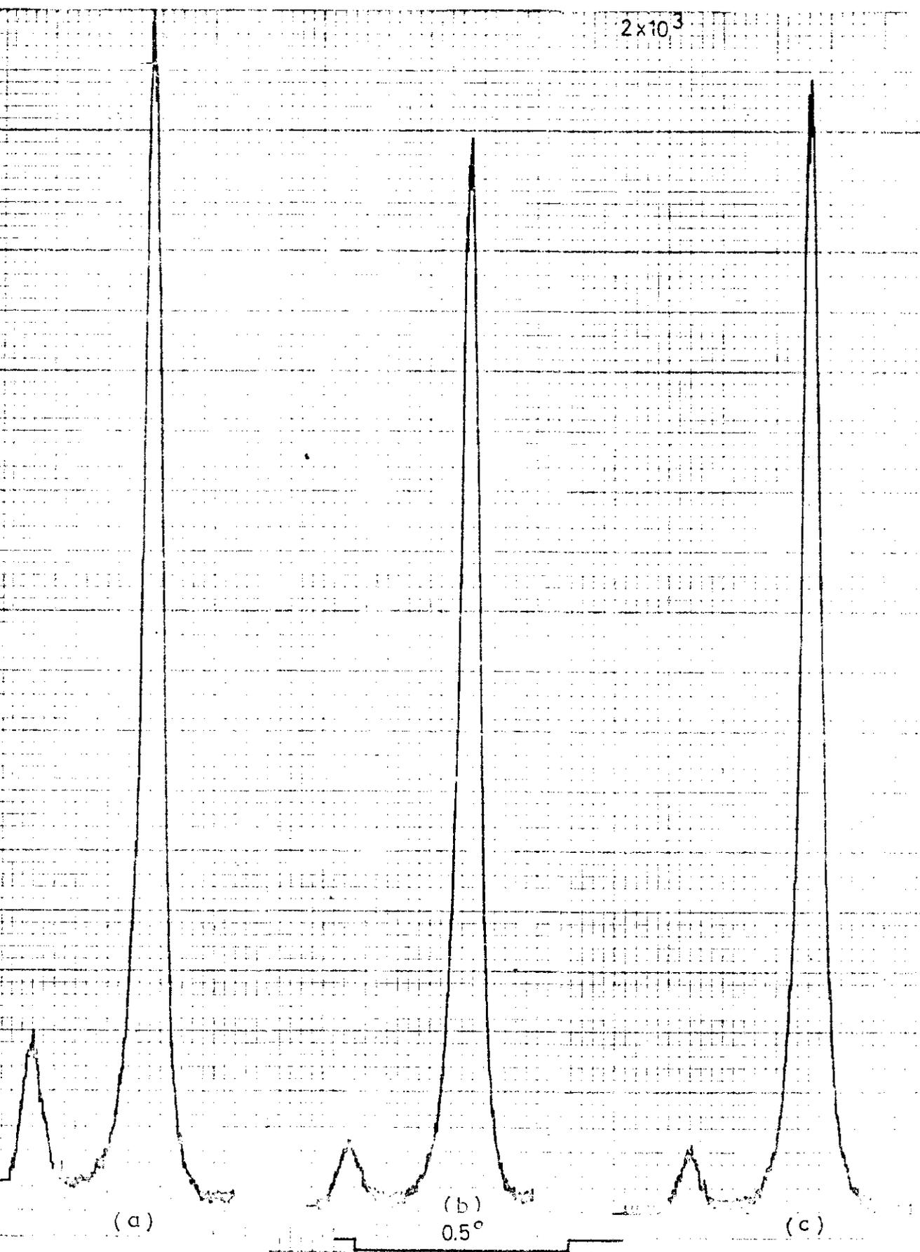
IG- 5-1 Etapas sucessivas no processo da monocromatização do feixe incidente. Os valores da relação  $K\alpha_2/K\alpha_1$  são: (a) 0,15- (b) 0,07, (c) 0,05. Os gráficos foram obtidos com varredura  $\theta: 2\theta$  usando um cristal perfeito de Germânio orientado segundo a direção (333)
