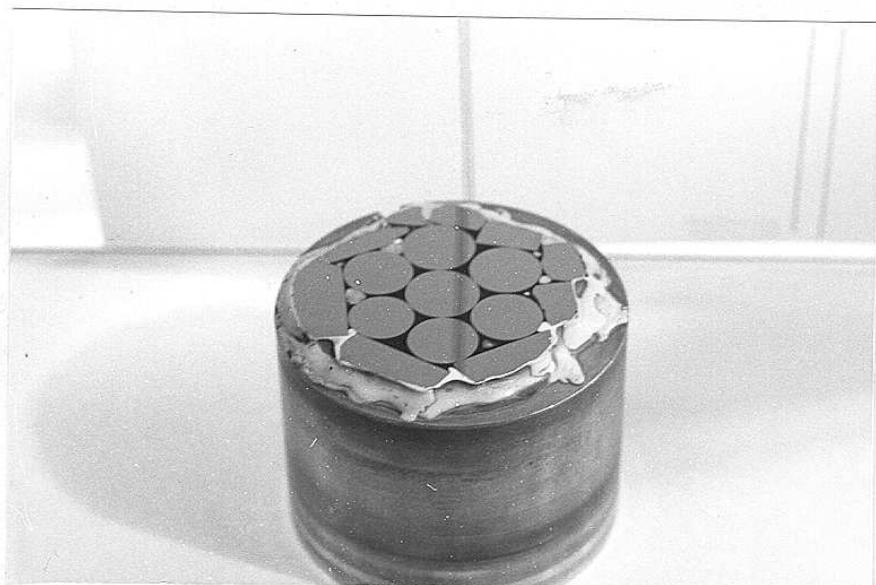
Sendo assim, uma análise mais precisa foi realizada utilizando um microscópio de interferência. Desta análise é possível verificarmos a forma e qualidade da superfície polida.
