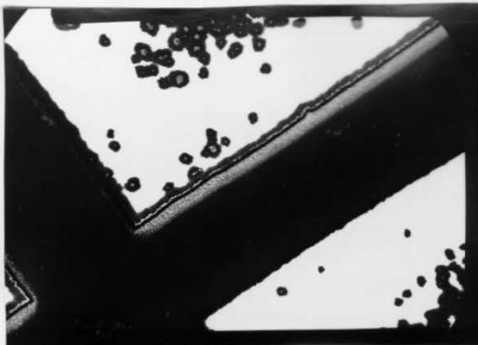
Foto 18- Cristal de NaCl com filme de Ag.
