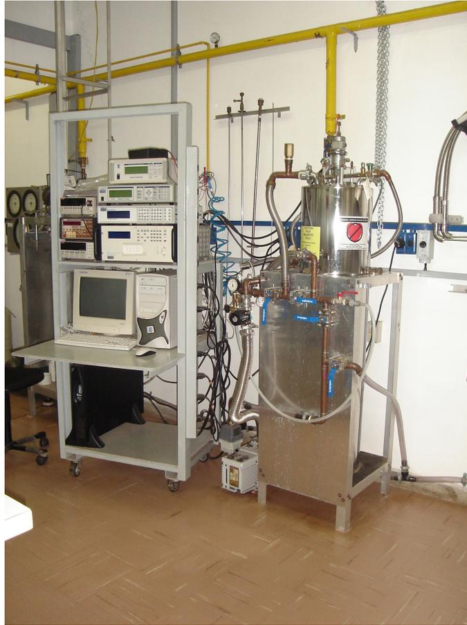
Figura 3.3: O criostato da Janis Research utilizado para medidas de transporte.
