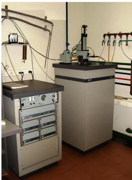
Figura 3.5: Magnetômetro SQUID utilizado nas medidas de magnetização em função da posição da amostra.
