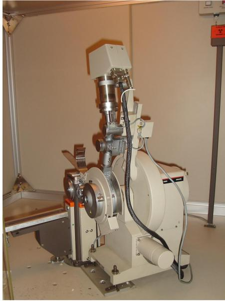
Figura 3.9: O difratômetro de raios-X Philips utilizado neste trabalho
