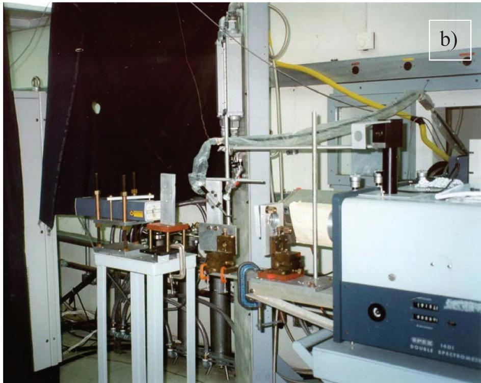
**Figura 3.3:** a) Foto do sistema de coleta de sinal óptico do gap entre os eletrodos; b) foto do sistema óptico de acoplamento com o espectrômetro.
