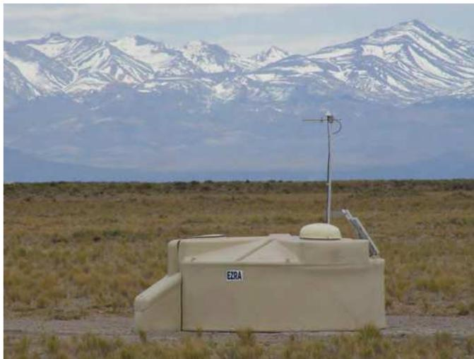
Figura 3.2: Detector de superfície do Observatório Pierre Auger.
