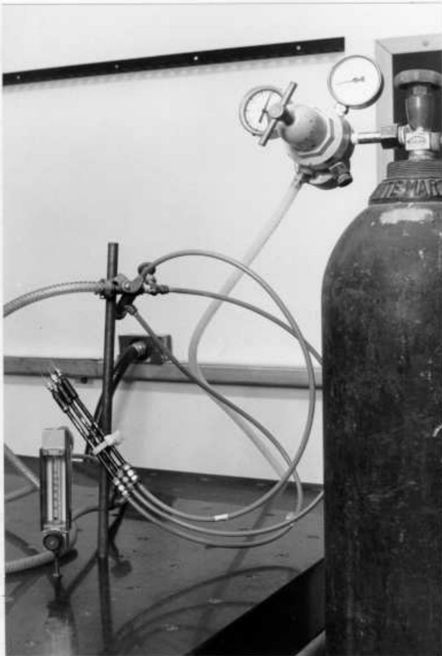
Fig. IV3.1 - Sistema de fusão. Ve-se a fonte de calor, o rotâmetro e as microchamas (canetas + agulhas). Ve-se também as válvulas individuais das microchamas.
