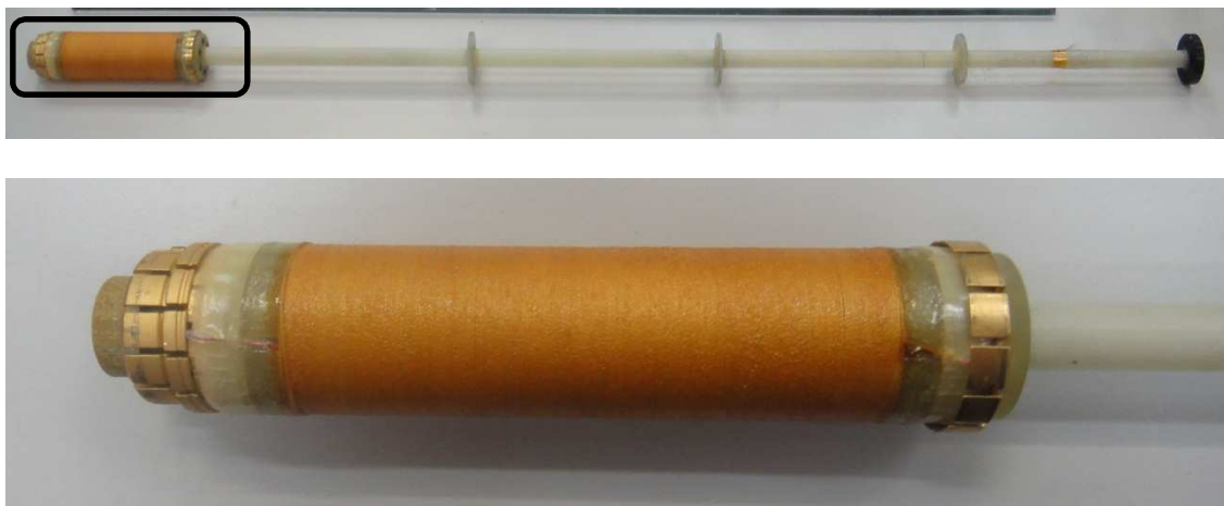
Figura 3.6: Sonda magnetométrica, onde é inserida a amostra. Na imagem ampliada, vemos a bobina utilizada para gerar o campo AC.
