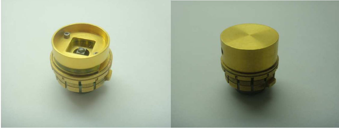
Figura 3.8: Fotos do puck de capacidade térmica. À esquerda temos o puck sem o shield, mostrando a plataforma (com uma amostra no centro) conectada ao puck por quatro fios e à direita vemos o puck montado com o shield.
