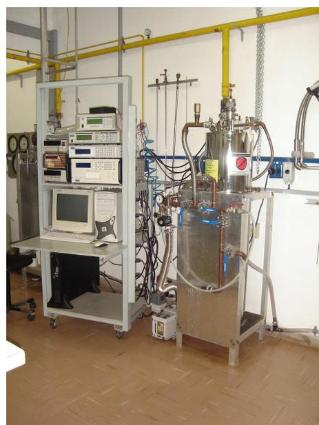
Figura 3.4: Criostato Janis, utilizado nas medidas de transporte contra temperatura e com campo magnético aplicado, utilizado nas amostras de grafite sobre silício.
