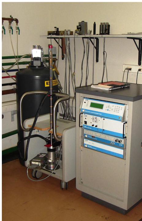
Figura 3.3: Plataforma de medidas PPMS-9T da Quantum Design, utilizado nas medidas elétricas das amostras de grafite sobre silício.
