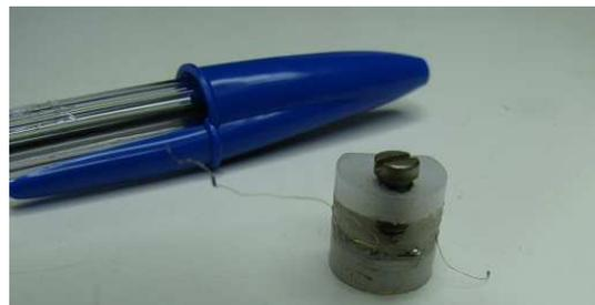
Figura 3.10: Foto mostrando dispositivo fabricado para prender um filme de grafite sobre um pedaço de wafer de silício.
