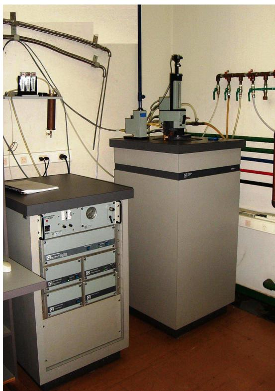
Figura 3.2: Magnetômetro SQUID modelo MPMS-5T da Quantum Design, utilizado nas medidas de magnetização.
