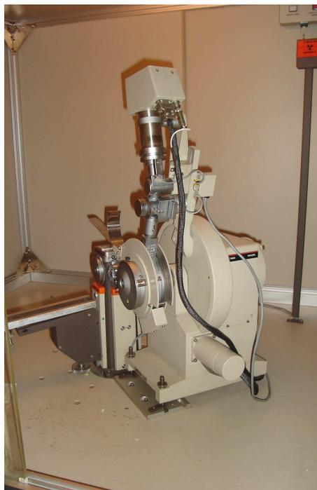
Figura 3.1: Foto do difratômetro Philips utilizado nas medidas de raios-x em pó.
