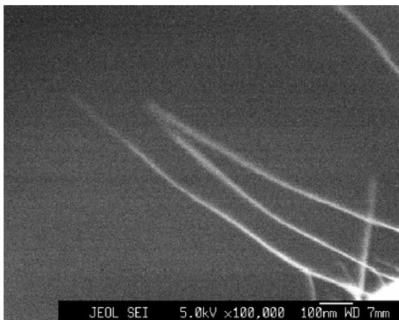
Figura 4.1: Micrografia da amostra obtida a partir do catalisador ZrCo<sub>2</sub>.
