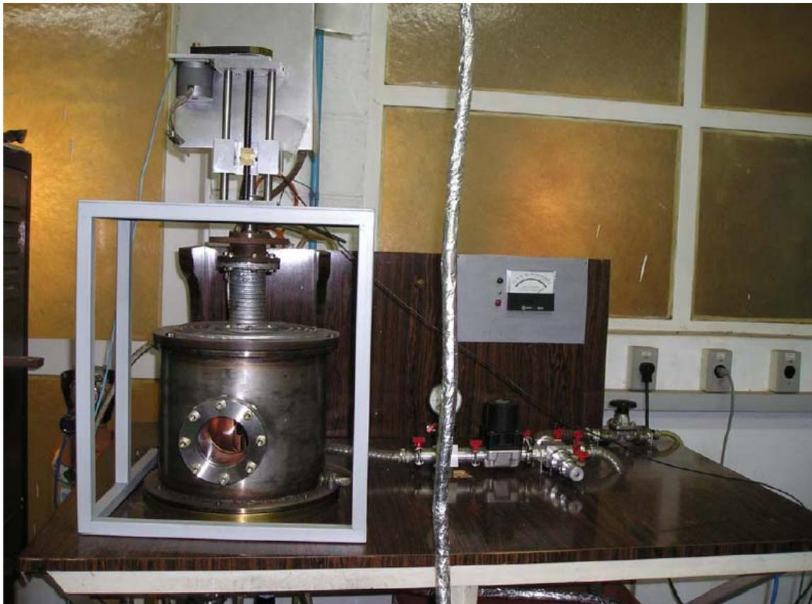
Figura 3.6: Vista geral do Forar II com o sistema mecânico de avanço do cátodo acoplado.
