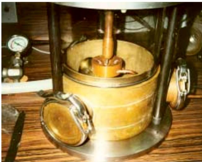
Figura 3.12- A vista geral mostra os eletrodos da primeira versão do equipamento para tratamento térmico de partículas sólidas.
