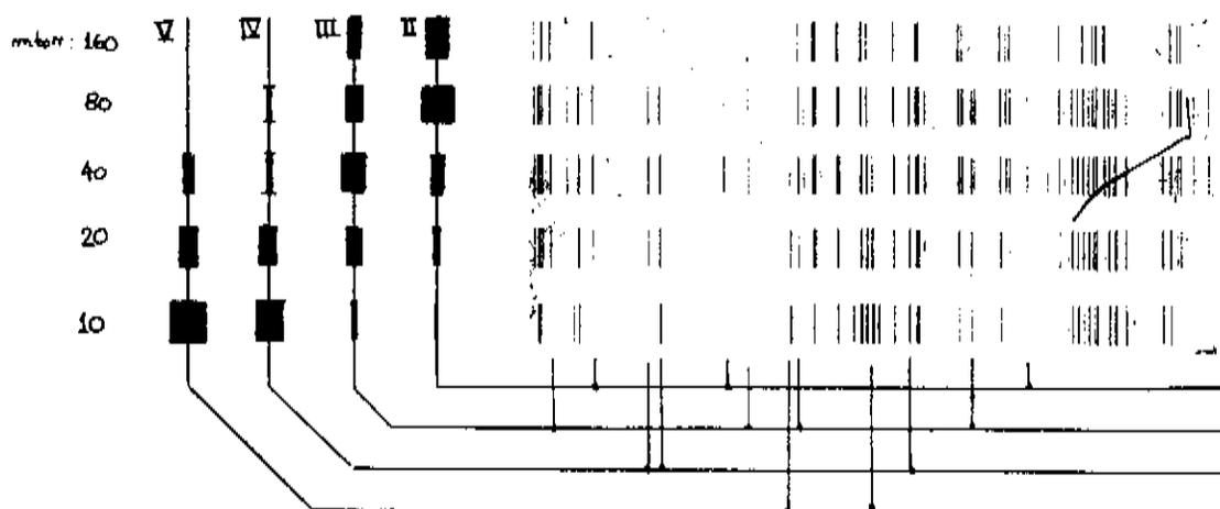
Figura 3.9: *Desenho representativo das intensidades para diferentes graus de ionização e Foto da placa que registrou essa informação.*
