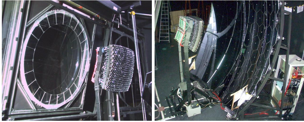
Figura 2.5: Fotos do telescópio protótipo do Observatório Auger. A foto à esquerda mostra a câmara de fotomultiplicadoras e o anel corretor. A foto à direita mostra o espelho e a câmara de fotomultiplicadoras vista por trás.
