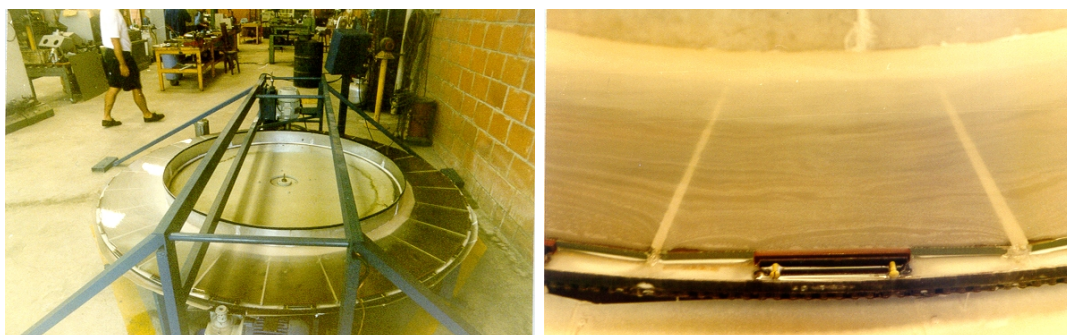
Figura 3.3: Máquina desenvolvida na Empresa Schwantz para a fabricação do anel corretor.
