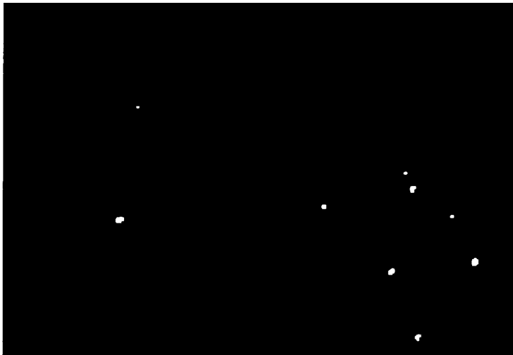
Foto 4.6 A mesma região da amostra de acima, após de um mês. Observamos um aumento maior na quantidade da densidade de pinholes com respeito a amostra não hidrogenada.
