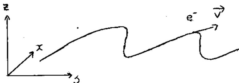
FIG.14. ILUSTRAÇÃO DA TRAJETÓRIA DE UM ELÉTRON EM UM ONDULADOR.
