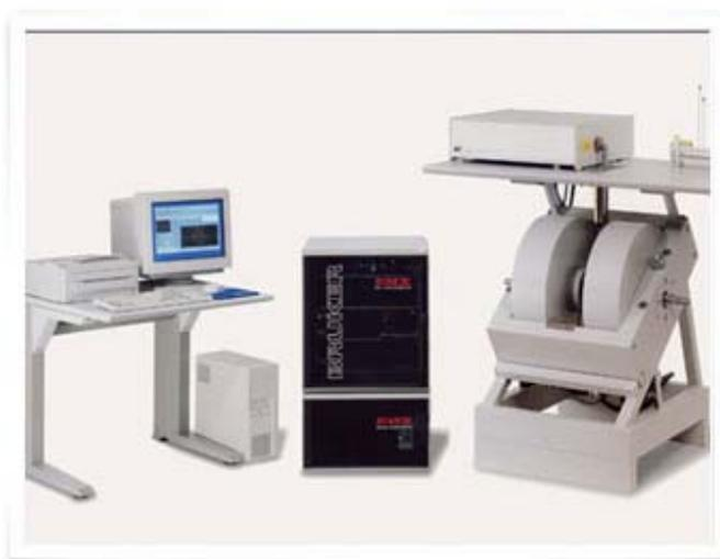
Figura 4.4 – Um espectrômetro de RPE (modelo Bruker E-500). No canto esquerdo temos um micro para aquisição de dados, ao centro o console e a direita um magneto com a fonte de microondas.
