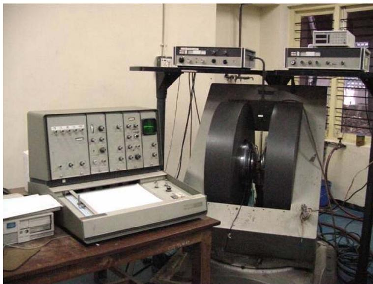
*Figura 4.5 – Espectrômetro de RPE modelo Varian E-112. A cavidade de microondas nele utilizada em nossas medidas também foi  $TE_{102}$ .*
