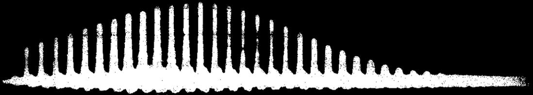
Figura 4.6: Sinal do trem de pulsos do laser no osciloscópio. O intervalo temporal entre os pulsos sucessivos no trem é de 25 ns (tempo de trânsito na cavidade)
