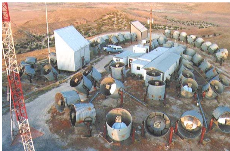
Figura 2.19 – Estação I do experimento Fly's Eye , em Dugway, Utah, Estados Unidos. Cada telescópio se encontra na orientação definida para coleta de dados, cobrindo uma região específica do céu. Foto extraída de [52].
