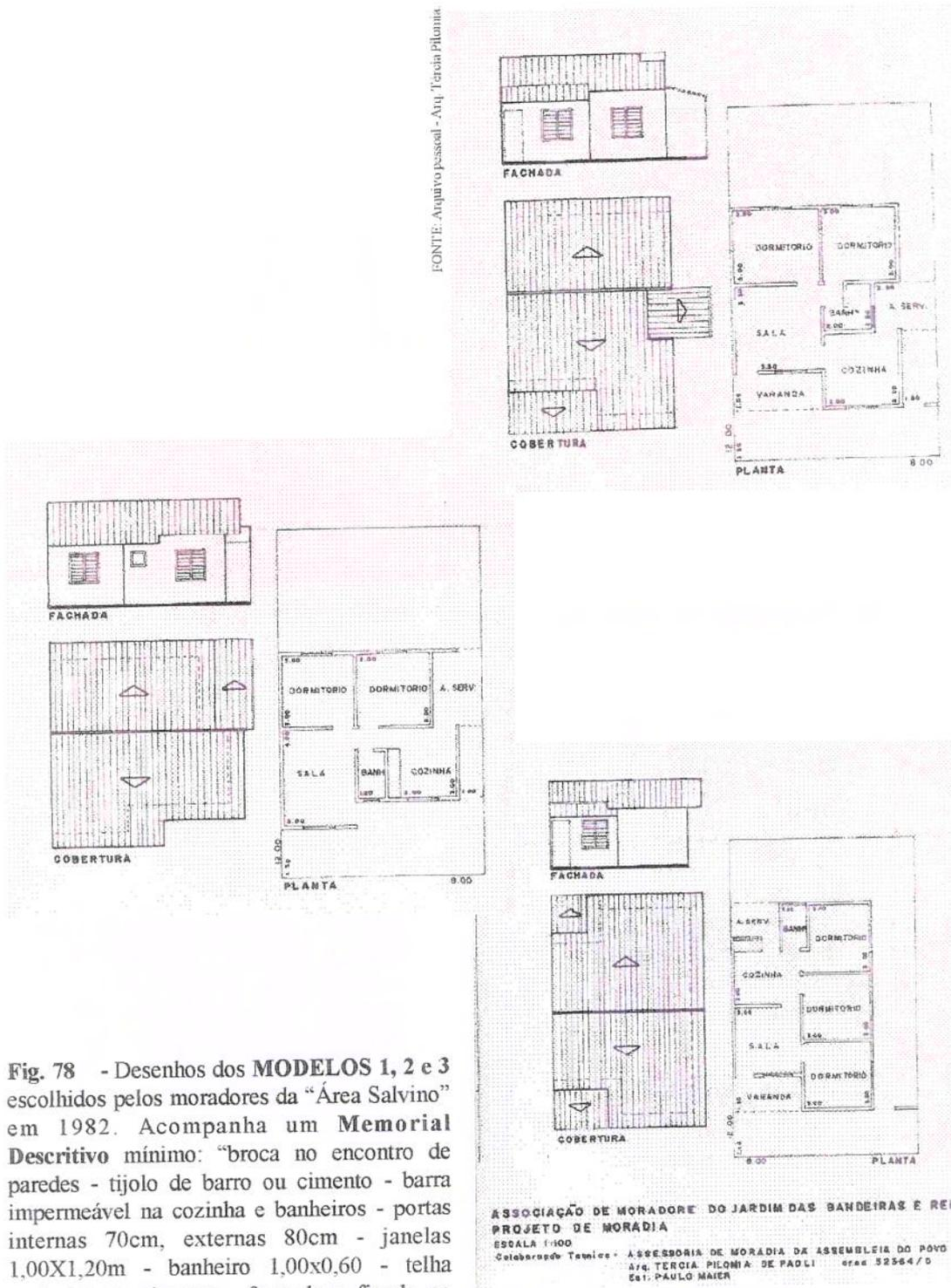
**Fig. 78** - Desenhos dos **MODELOS 1, 2 e 3** escolhidos pelos moradores da “Área Salvino” em 1982. Acompanha um **Memorial Descritivo** mínimo: “broca no encontro de paredes - tijolo de barro ou cimento - barra impermeável na cozinha e banheiros - portas internas 70cm, externas 80cm - janelas 1,00X1,20m - banheiro 1,00x0,60 - telha cerâmica ou cimento - forro leve fixado ao madeirame ou laje - caixa d’água 500litros.”
