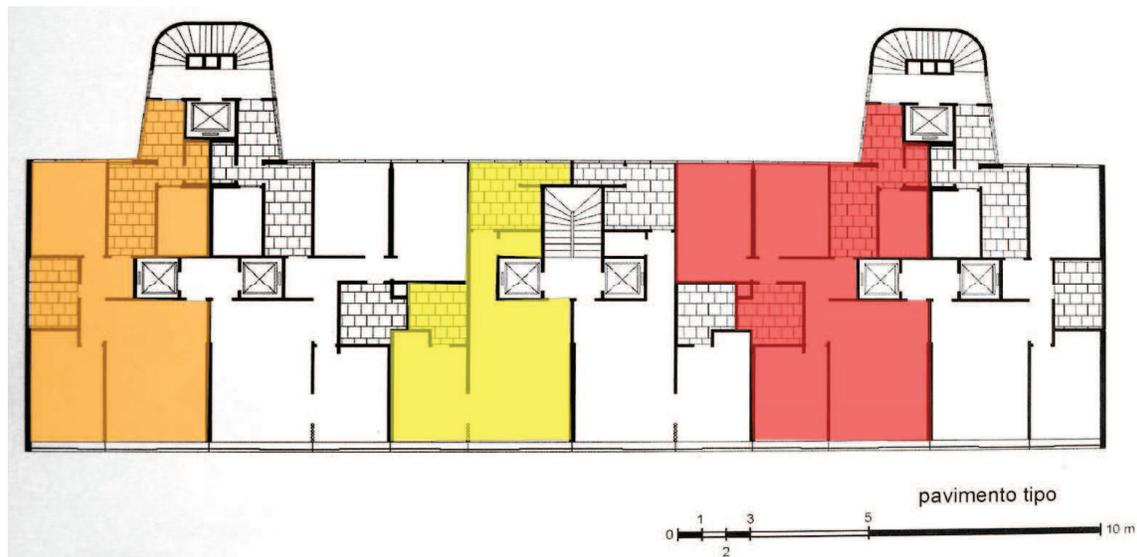
Figura 139: Pavimento tipo – em laranja a tipologia A, em amarelo a B e em vermelho a C
