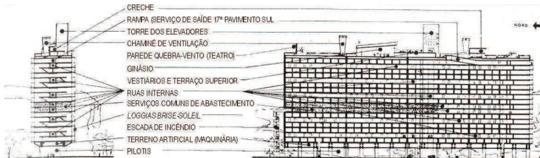
**Figura 08: Unité d’Habitation - Seção e desenho em projeção.** Projeto de Le Corbusier em Marselha, 1947-1952 – 12 pavimentos e 23 tipologias de plantas para famílias de uma a dez pessoas
