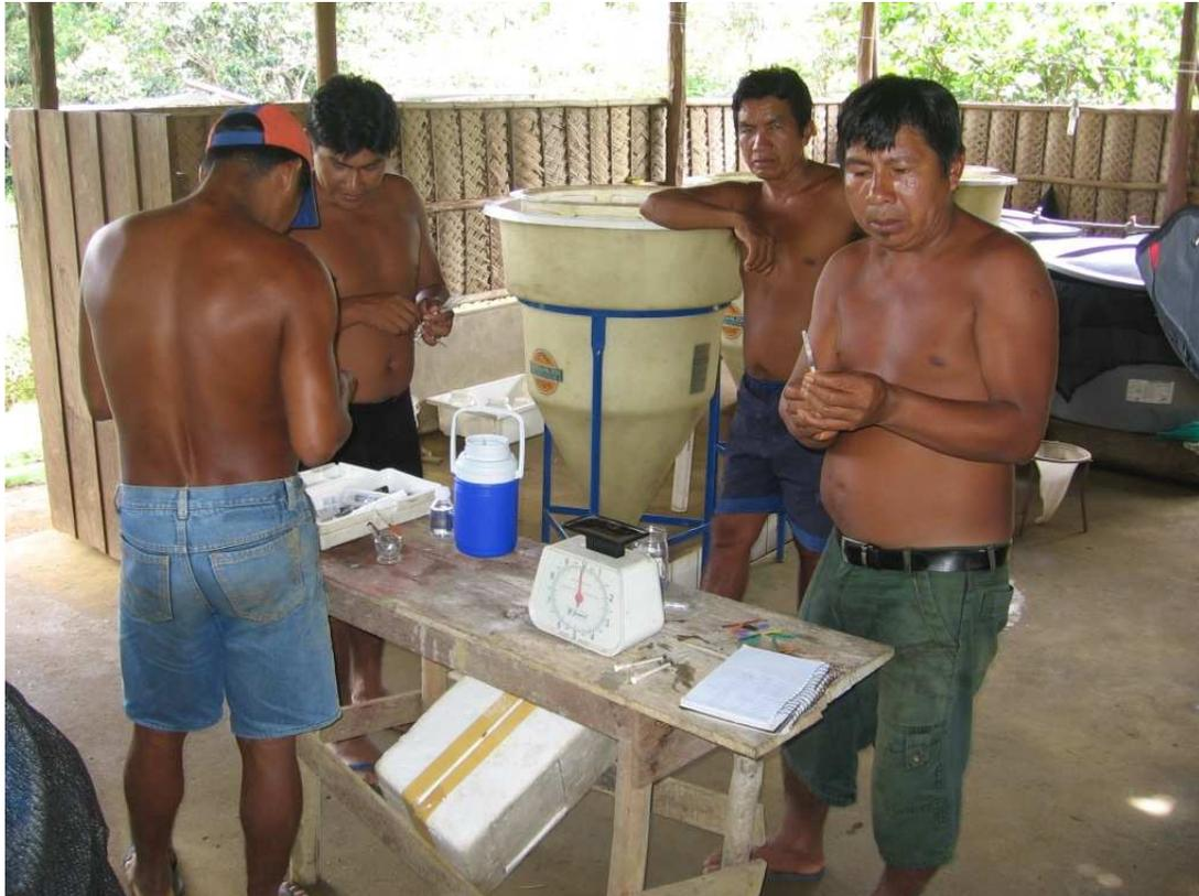
**Imagem 16 – Equipe indígena preparando as doses de hormônios para os peixes. A sua frente, a bancada com o equipamento necessário ao processo; ao fundo, incubadora artificial.**
