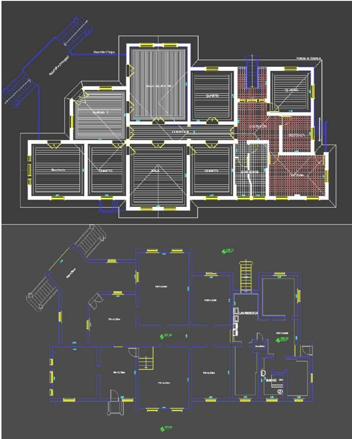
**Fig.48** – Reconstituição da Planta original da Fazenda São Vicente, Campinas. Piso superior e porão respectivamente.
