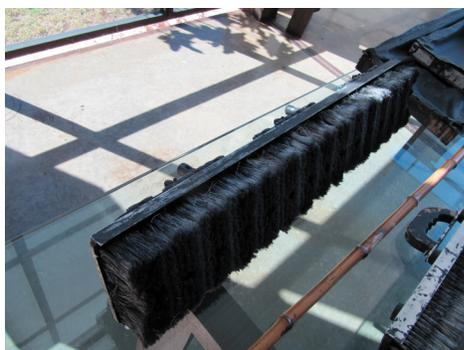
FIGURA 2.2a (acima) e 2.2b (ao lado) pincel-vassoura com alimentadores
