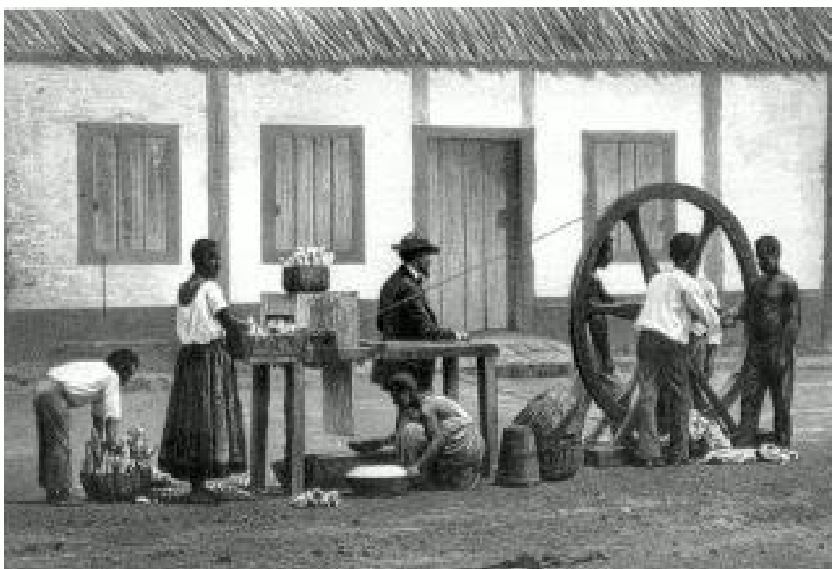
Fig. 30 - Roda de ralar: fotografia de Victor Frond feita em fazenda no Rio de Janeiro, em 1858.
