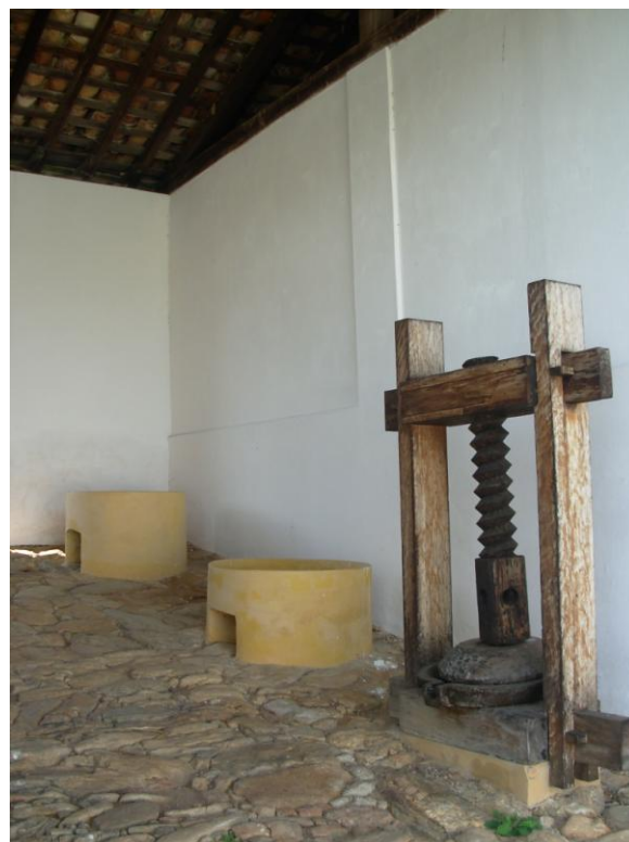
Fig. 88 - Café e técnica: Prensa e fornos, faz. Pau d'Alho.
