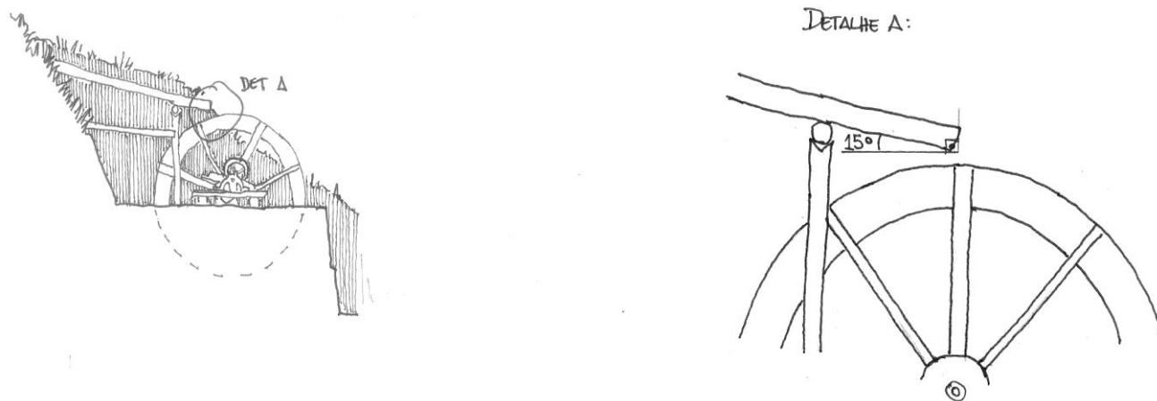
Fig. 64 - Situação atual: desenho esquemático da roda d'água do alambique Beija-flor, na serra do Itapeti. Note-se o ângulo raso em que o canal está posicionado em relação à roda.
