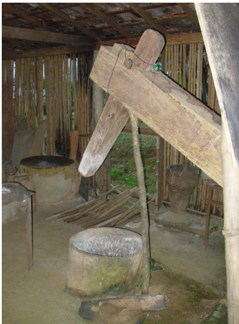
Fig. 75 - Macaco do monjolo : detalhe de monjolo em Paraty, no qual se vê o macaco e seu modo de amarração.
