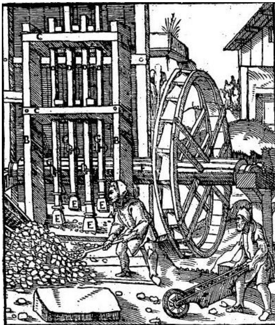
Fig. 59 - Novos usos para a velha roda: bateria de pilões para a metalurgia em desenho do tratado de Agricola, De re metallica. 1556.
