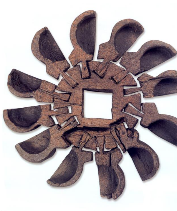
Fig. 47 - Rodízios: rodízio em madeira de Minas Gerais, século XIX. Acervo MAO-BH.
