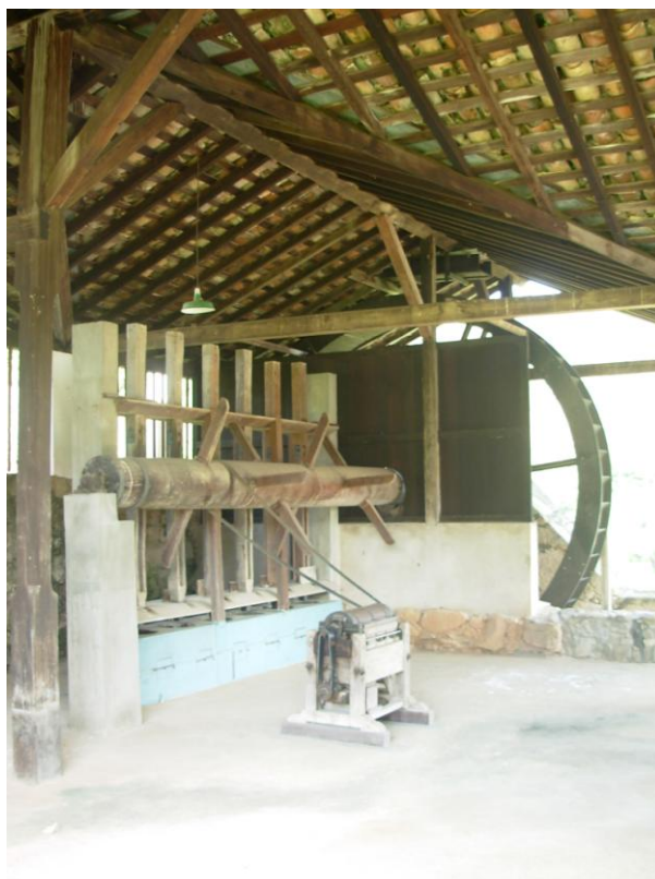
Fig. 86 - Café e técnica : Engenho de pilões, faz. Pau d'Alho.
