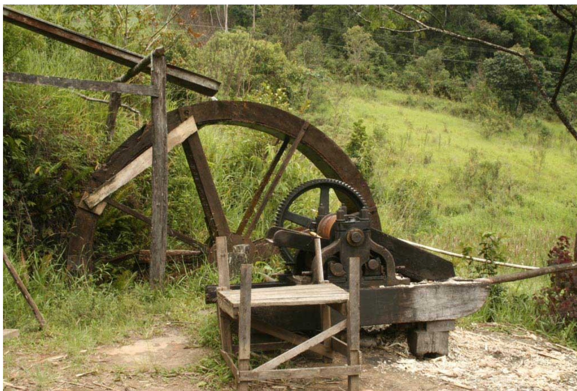
Fig. 63 - Alambique: roda d'água que aciona a moenda no alambique Beija-flor, em Mogi das Cruzes.
