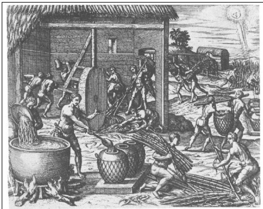
FIGURA 2.3: Emprego das moendas de mós de pedra no processamento da cana-de-açúcar.
