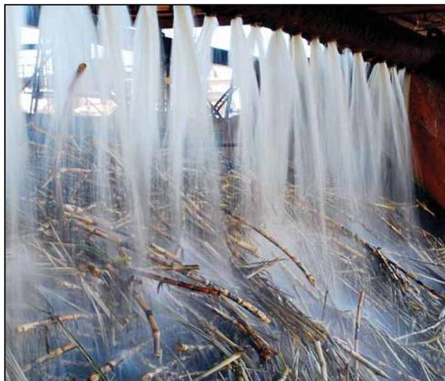
FIGURA 5.1: Operação de lavagem da cana-de-açúcar.
