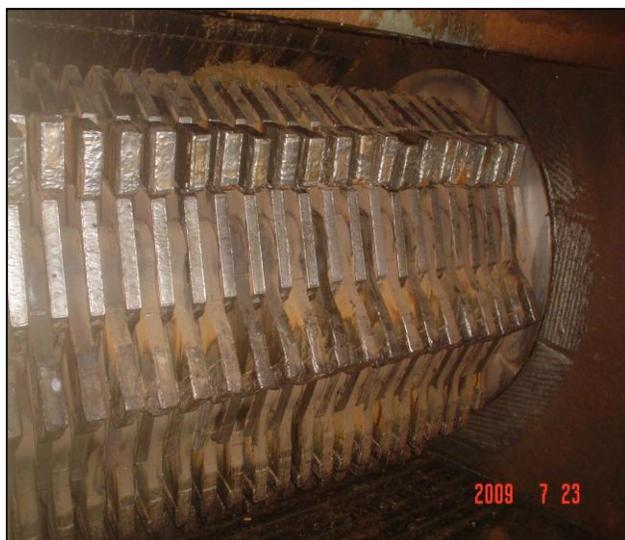
FIGURA 5.3: Conjunto de martelos do desfibrador.
