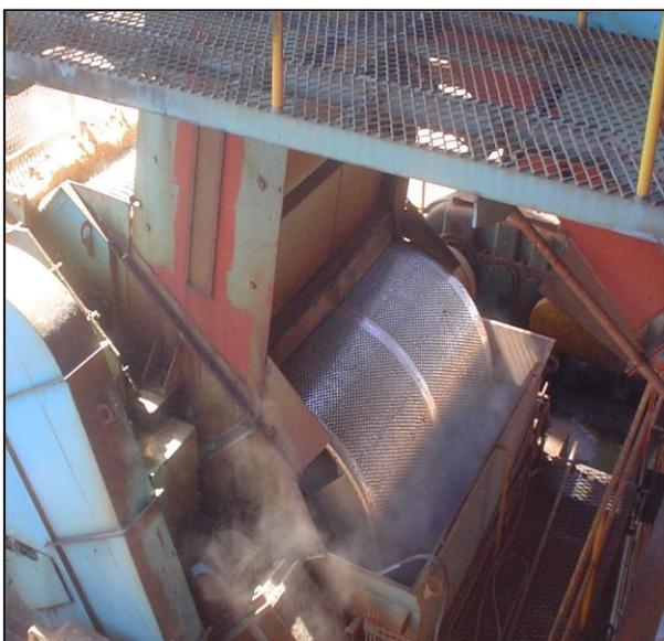
FIGURA 5.12: Terno desaguador (perfurado).
