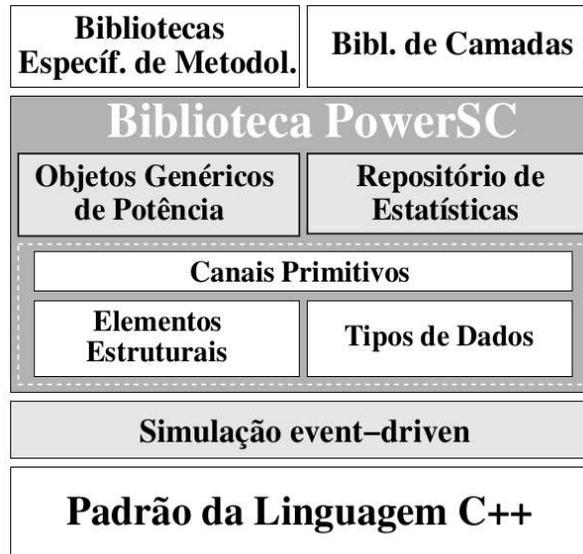
Figura 2.9: Estrutura da biblioteca de expansão PowerSC sobre a SDL SystemC
