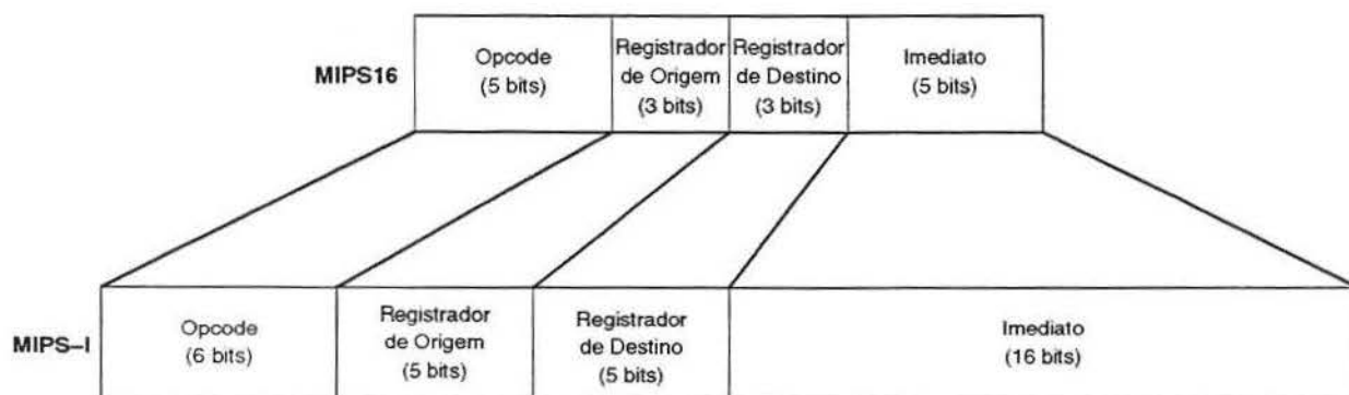
Figura 2.4: Conversão de uma instrução MIPS16 para o formato MIPS-I (32 bits)
