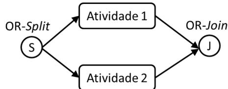
Figura 3.3: Elementos OR-Split e OR-Join na representação de fluxo condicional.
