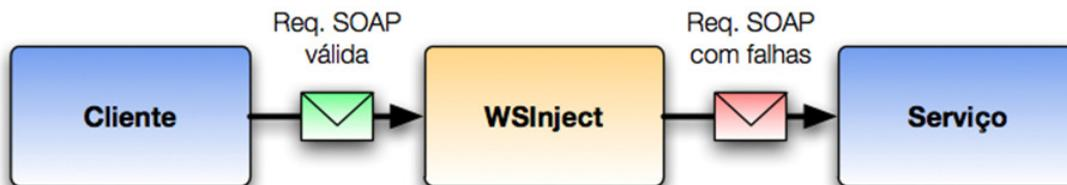
Figura 14. WSInject atuando como injetor de falhas no momento da requisição.
