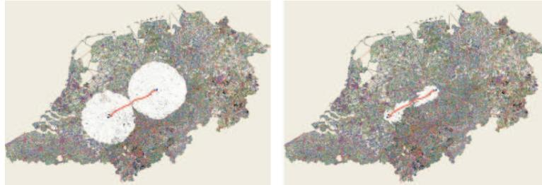
Figura 4.3: Áreas visitadas pelo algoritmo de Dijkstra bidirecional, à esquerda, e pelo algoritmo A\* bidirecional, à direita [KP06]. Enquanto a área visitada pelo primeiro consiste de dois círculos justapostos centrados em  $s$  e  $t$ , a área do segundo consiste de duas pequenas elipses justapostas. O mapa é o mesmo da Figura 4.2.
