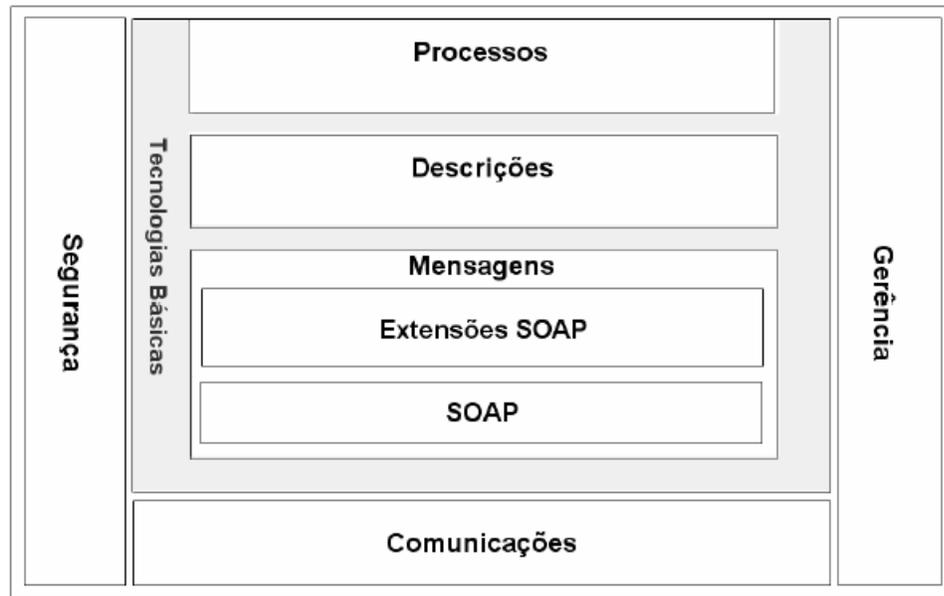
Figura 2.2: Estrutura básica de um serviço Web.
