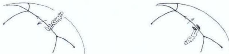
Figura 2.5: Orientações internas (ou longitudinais) e externas (ou transversais) de uma aresta.
