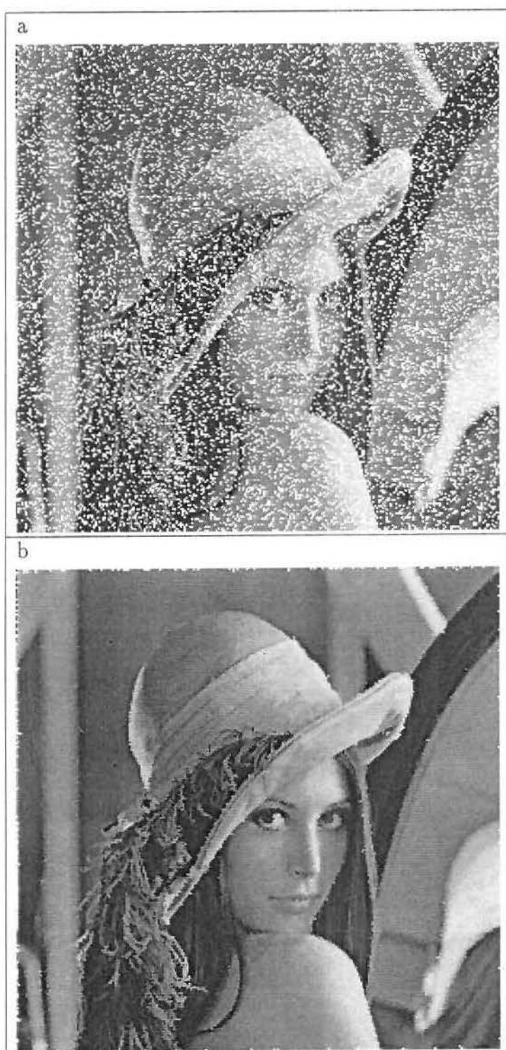
Figura A.14: Exemplo da operação de reconstrução para uma imagem em níveis de cinza: a) a imagem original, b) o resultado da reconstrução usando como imagem marcadora a erosão da imagem original por um círculo de raio 1
