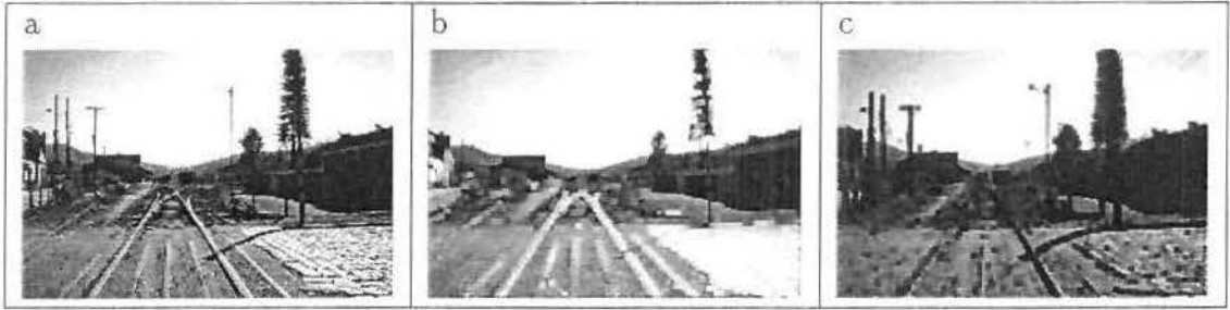
Figura A.11: Exemplo das operações de dilatação e erosão para imagens em níveis de cinza: a) a imagem numérica original, b) o resultado da dilatação por um círculo de raio 1, c) o resultado da erosão pelo mesmo elemento estruturante.
